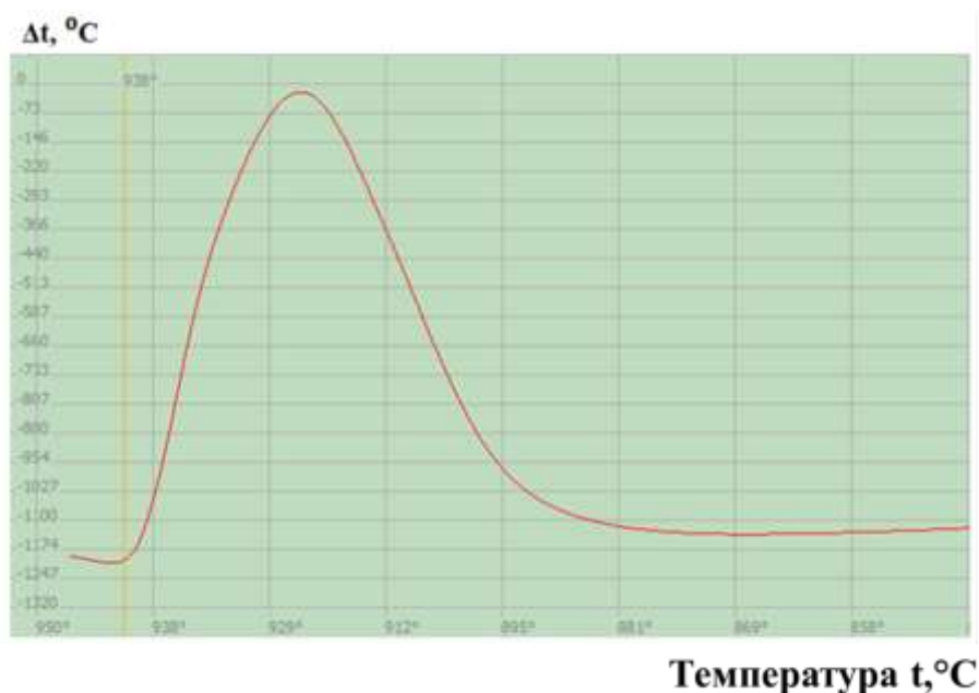
Рисунок 3.3 – Дифференциальная кривая охлаждения квазидвойной эвтектики e_1 938
