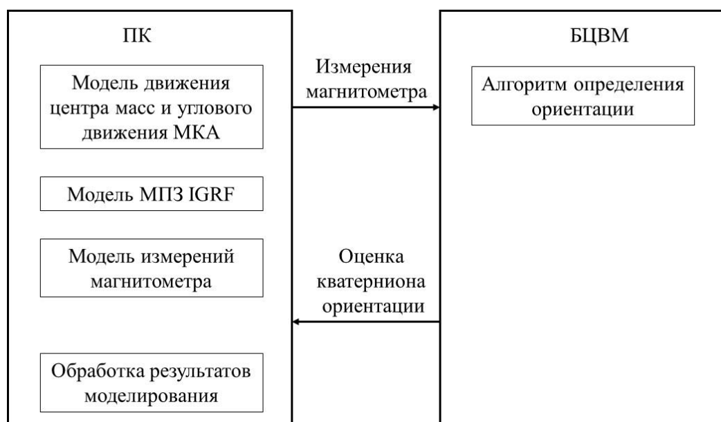
Рисунок 3.19 – Схема программно-аппаратного моделирования работы алгоритма
