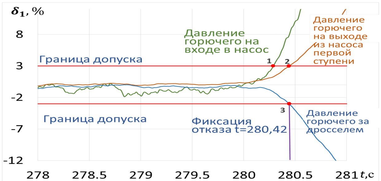
Рисунок 5.3 б) – Контроль отклонения текущих средних значений параметров двигателя от эталонных: три первых параметра, вышедшие за границу допуска
