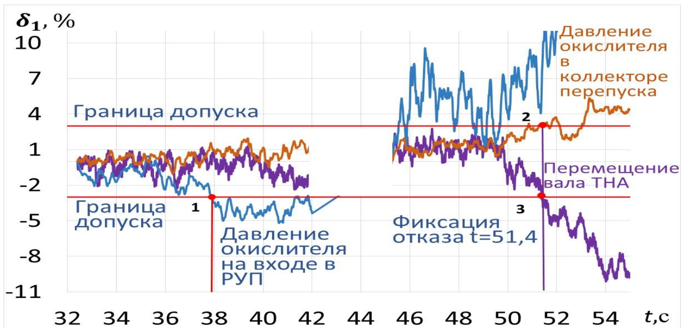
Рисунок 5.7* б) – Контроль отклонения текущих средних значений параметров двигателя от среднего измеренного значения в начале режима: три параметра, вышедшие за границу допуска
