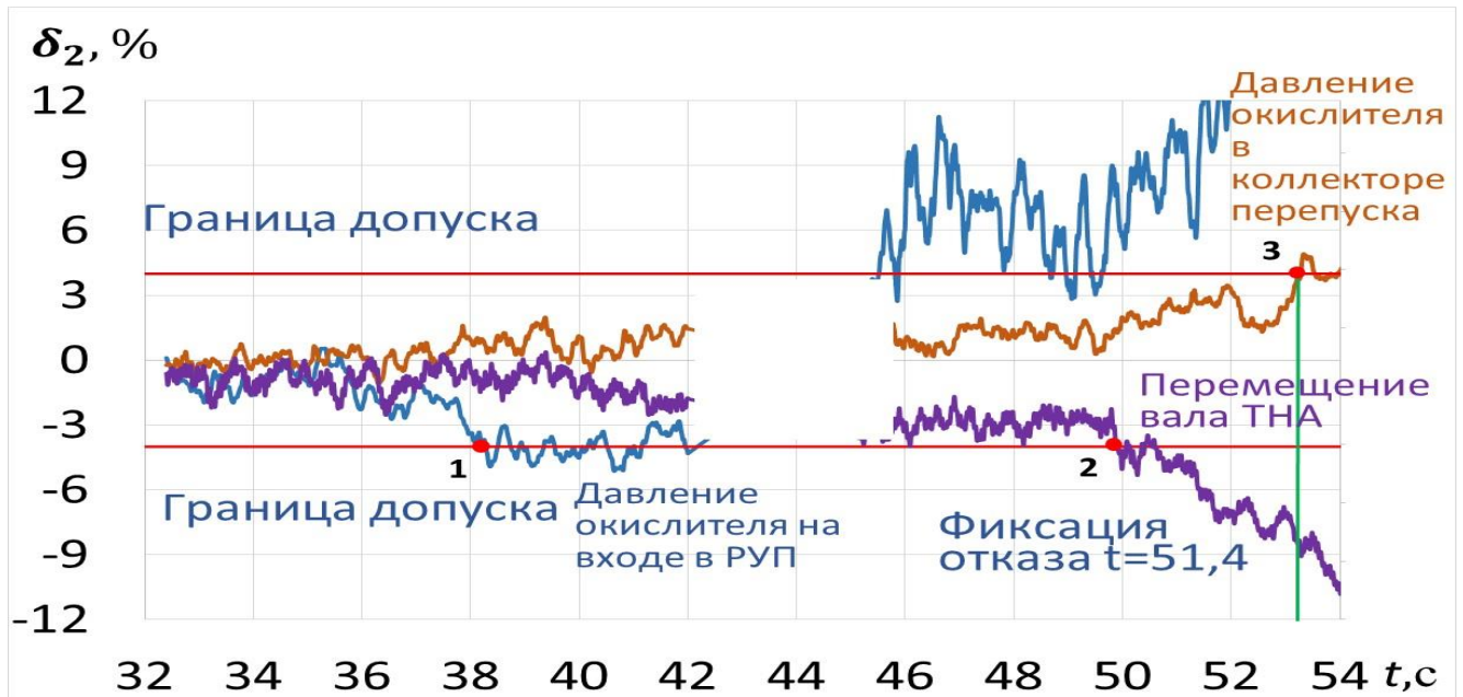
Рисунок 5.8 б) – Контроль отклонения измеренных параметров от расчётных по математической модели: три параметра, вышедшие за границу допуска
