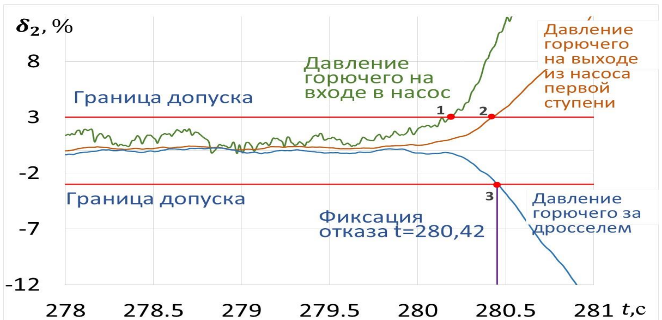
Рисунок 5.4 б – Контроль отклонения измеренных параметров от расчётных по математической модели: три параметра последовательно выходят за границы допуска
