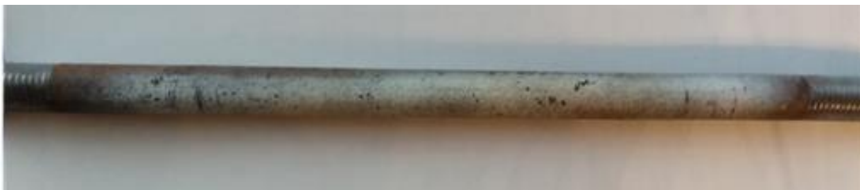
Рисунок 3.4 – Образец №1 после обработки с покрытием спеклом
