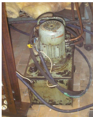
Рисунок 6.19 – Машина для правки с нагревом с гидравлическим приводом
