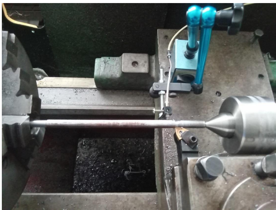
Рисунок 6.1 – Схема контроля оси вала датчиком Bently Nevada
