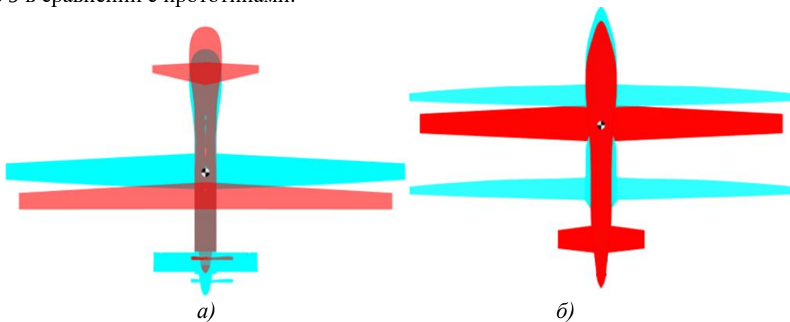
Рисунок 9 – Облики БПЛА по прототипам (синий) и после оптимизации (красный): а) БП-1; б) БП-2
