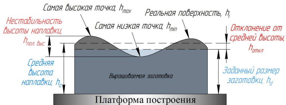
Рисунок 3.40 – Схема определения параметров рельефа верхней поверхности
