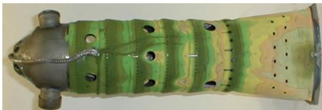
Рисунок 6 – Жаровая труба камеры сгорания ГТЭ-10/953 с термоиндикаторной краской после испытаний
