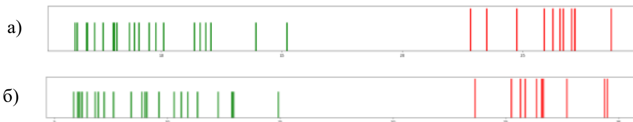
Рис. 3. Результаты расчета мер близости пар векторов признаков при предобработке а) методом [5], б) методом [4]. Зеленым отмечены меры пар, составленных из фрагментов одной аудиозаписи, красным – из фрагментов различных
