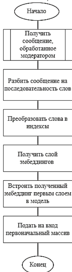
Рис. 1. Алгоритм добавления Embedding-слоя в нейронную сеть
