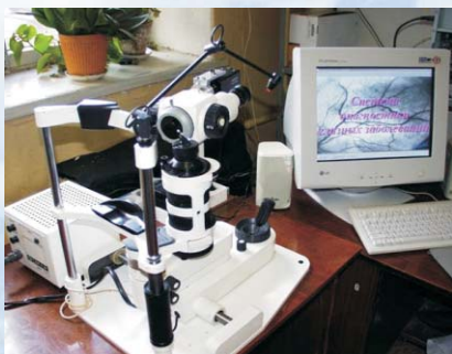
Опτικο-цифровая система ранней диагностики глазных заболеваний по анализу изображений глазного дна
