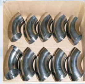
Промышленная партия тонкостенных крутоизогнутых отводов из стали 12X18H10T
