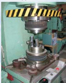
Штамповая оснастка для штамповки на универсальных прессах тонкостенных тройников
