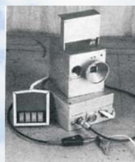
Мнопараметрический детектор утечки воздуха из междупланетной космической станции (МКС)
