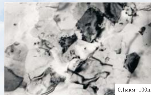
Мелкозернистая блочная структура сплава АК9 при степени обжатия 99,98% (14 проход)
