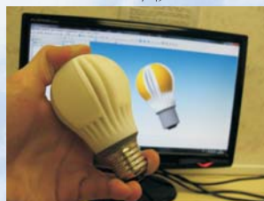
3D - модель светодиодной лампы с корпусом-радиатором из теплоотводящего пластика
