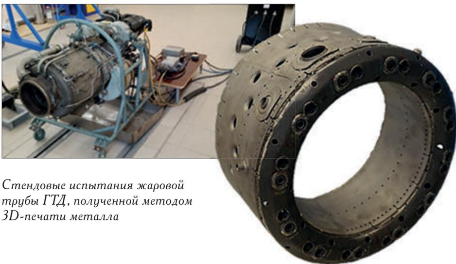
Стендовые испытания жаровой
