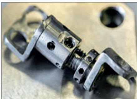
*Опытный образец имплантата шейного отдела позвоночника*
