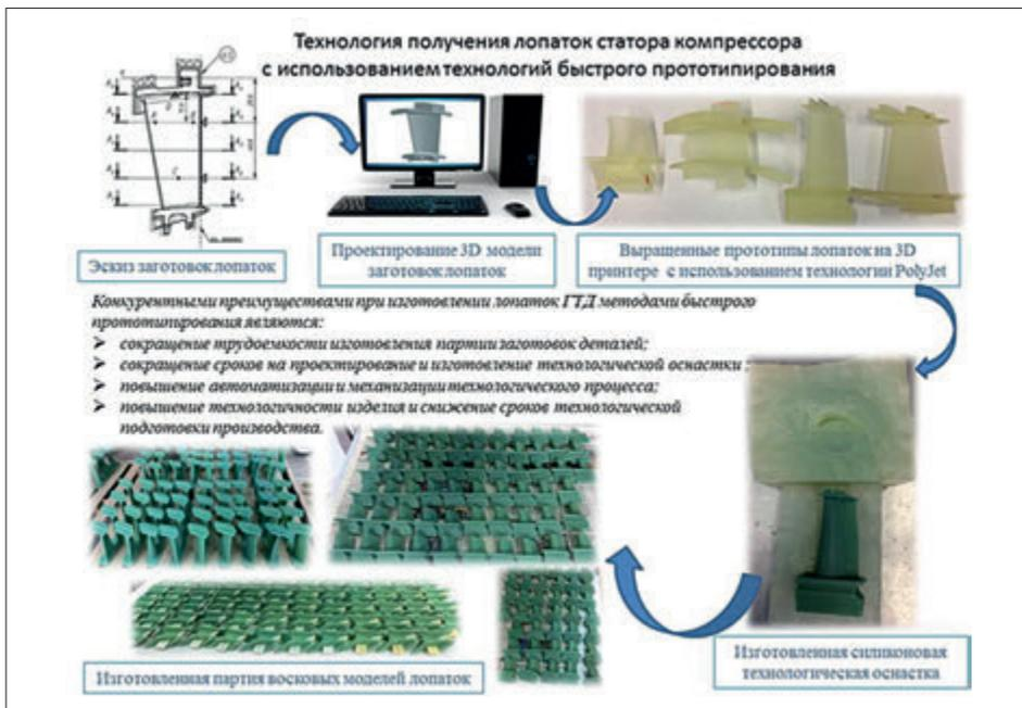
*Пример комплексного использования установок лаборатории для изготовления опытных партий восковых моделей лопаток МГТД*
