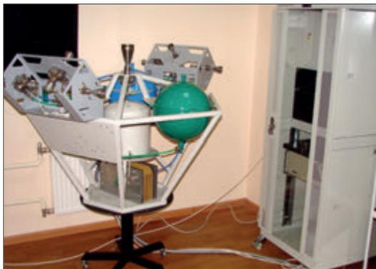
*Макет двигательной установки на основе электролиза воды*
