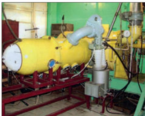
Стенд для испытаний ЖРДМТ
