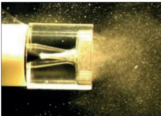
*Работа газожидкостной форсунки*
