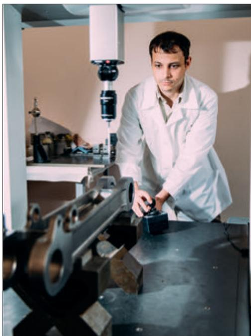
Контроль изготовленной детали на координатноизмерительной машине в САМ-центре
