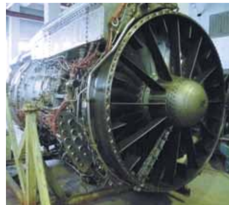
➤ НК-88 — пока единственный двигатель, способный работать на сжиженном водороде
