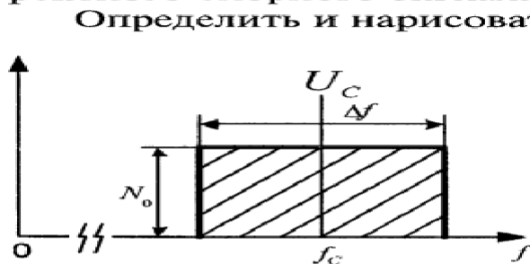
Рис. 6. Спектр шума (заштрихован) и сигнала на входе синхронного детектора
