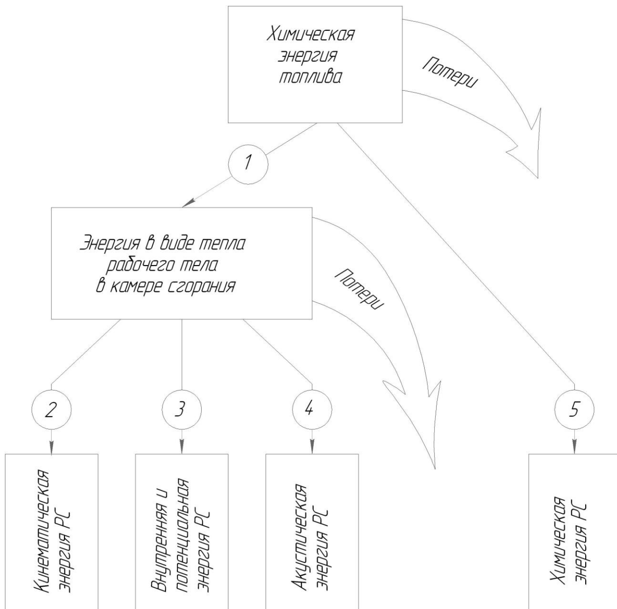
Рис. 2.17. Основные этапы преобразования энергии в ХГКПЭ.
