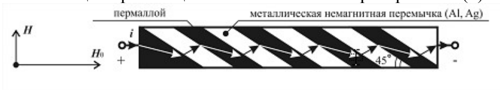
Рис. 1. Структура типа «barber-pole» единичного АМР-элемента Таким образом, учитывая, что
