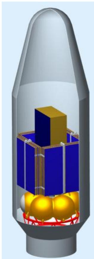
Рис. 1. Трёхмерная модель комбинированного блока выведения
