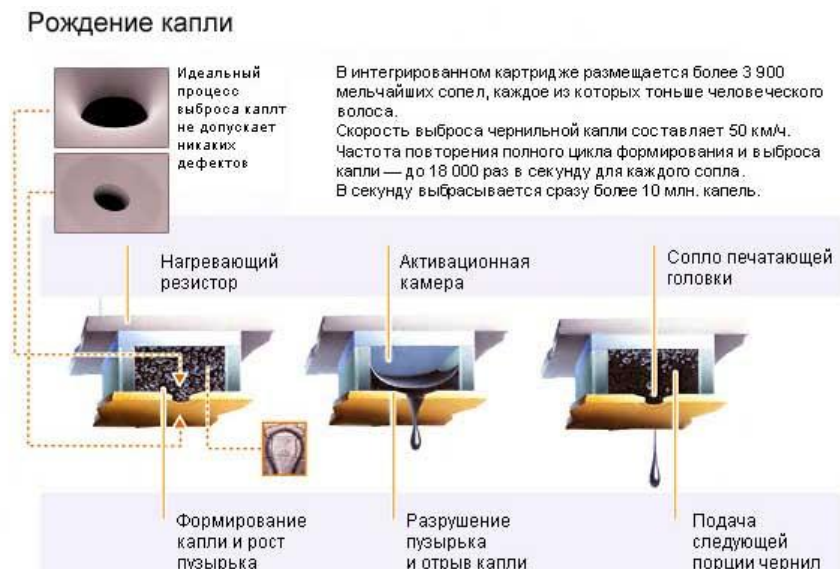
Рис. 2. Технология термоструйной печати
