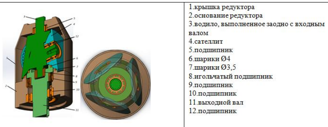
Рис. 1 Планетарный редуктор
