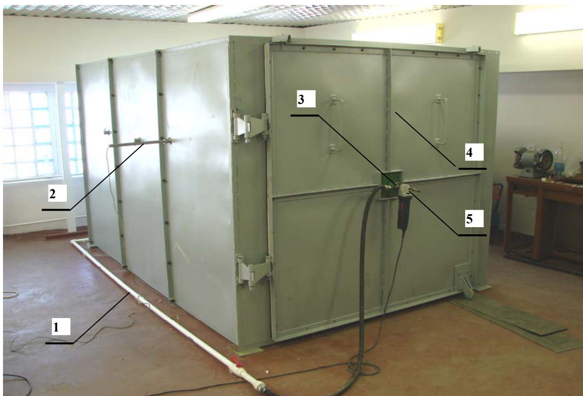
Рисунок 4.19 – Внешний вид малогабаритной акустической заглушенной камеры: 1 – полипропиленовый трубопровод для подвода сжатого воздуха; 2 – акустический зонд для измерения акустического излучения струи в камере; 3 – пульсатор воздушной струи; 4 – ворота для доступа в камеру; 5 – регулируемый электропривод пульсатора
