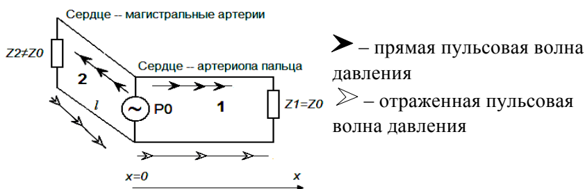
Рисунок 3.10 – Эквивалентная схема формирования фотоплетизмографического сигнала в артериях пальца руки
