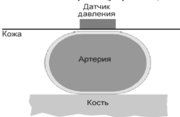
Рисунок 2.12 – Регистрация сигнала артериальной пульсации крови с помощью метода аппланационной сфигмографии
