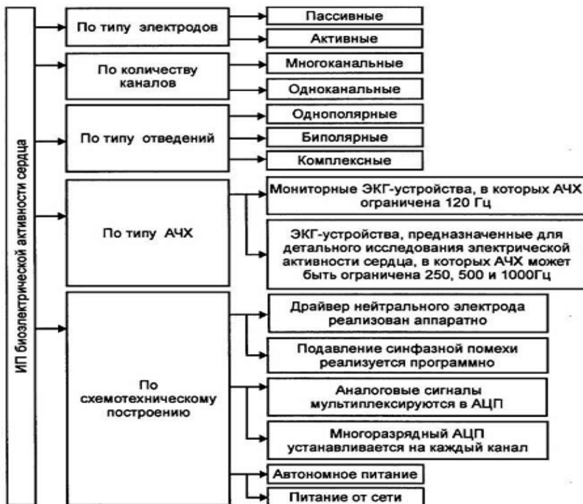
Рисунок 4.3 – Структурная схема классификации ИП биоэлектрической активности сердца
