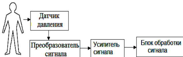
Рисунок 2.2 – Обобщенная структурная схема сфигмографического ИП артериальной пульсации крови
