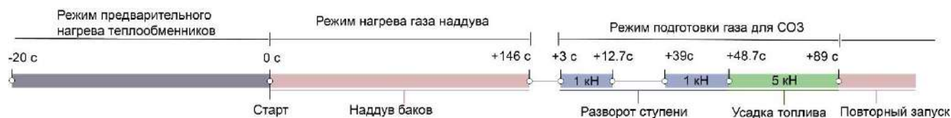
Рисунок 12 – Циклограмма работы ПГС возвращаемого РБ первой ступени РН
