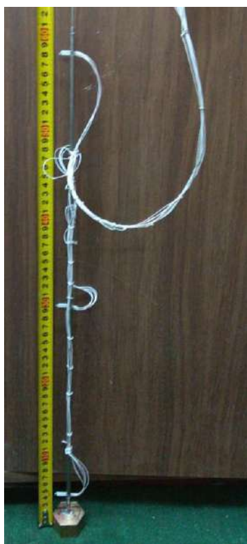
Рисунок 29 – Штанга с термометрами для измерения температуры газа и жидкости внутри СЁ
