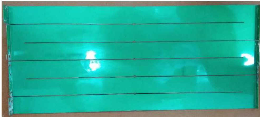
Рисунок 26 – Нагревательный элемент с защитным покрытием
