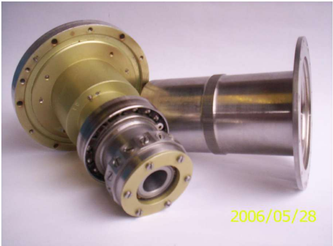
Рисунок 1.2 – Волновая зубчатая передача электропривода солнечной батареи КА «Ресурс-ДК»
