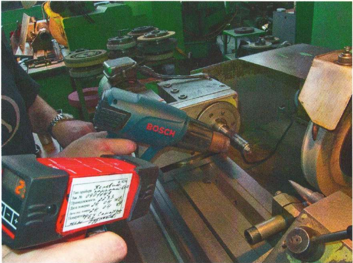
Рисунок 4.13 – Процесс нагрева рабочей части оправки перед установкой заготовки
