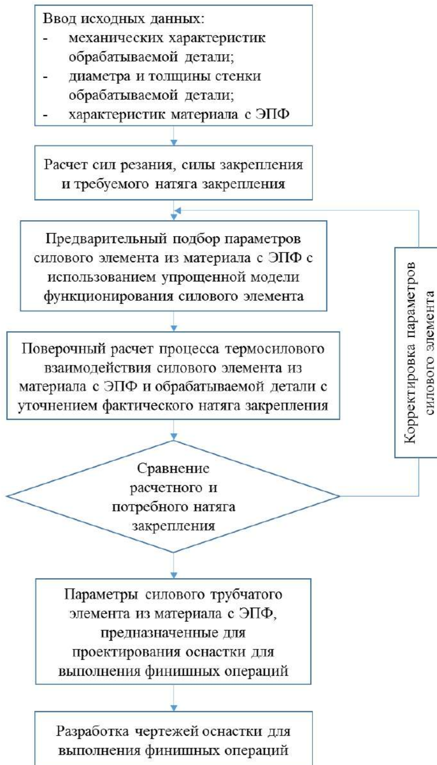
Рисунок 4.8 – Блок-схема методики проектирования приспособлений с рабочей частью из материала с ЭПФ для выполнения финишных операций механической обработки
