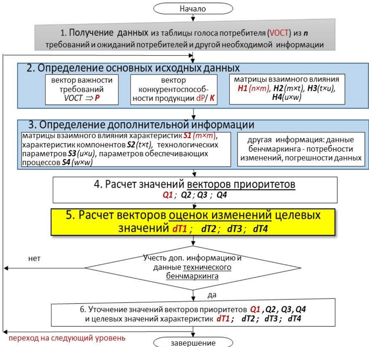
Рисунок 3.3 – Алгоритм методики MTQFD определения приоритетов и целевых значений характеристик и параметров
