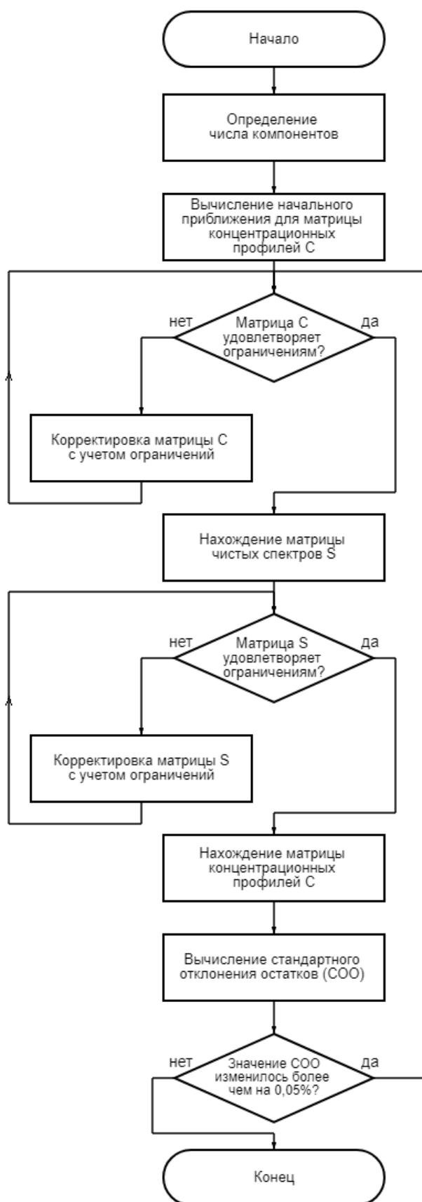
Рисунок 3.1 – Схема алгоритма компонентного разложения RS спектров
