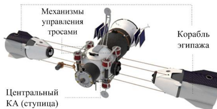
Рисунок 1.4 – Концепция испытательного стенда для ТГКА конфигурации «ступица-спицы» [44]
