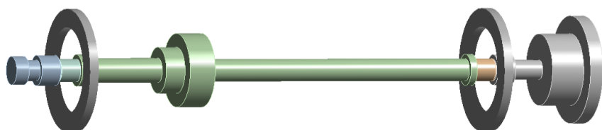
Рисунок Ж.6 – Внешний вид конечно-элементной модели имитатора ротора турбины низкого давления
