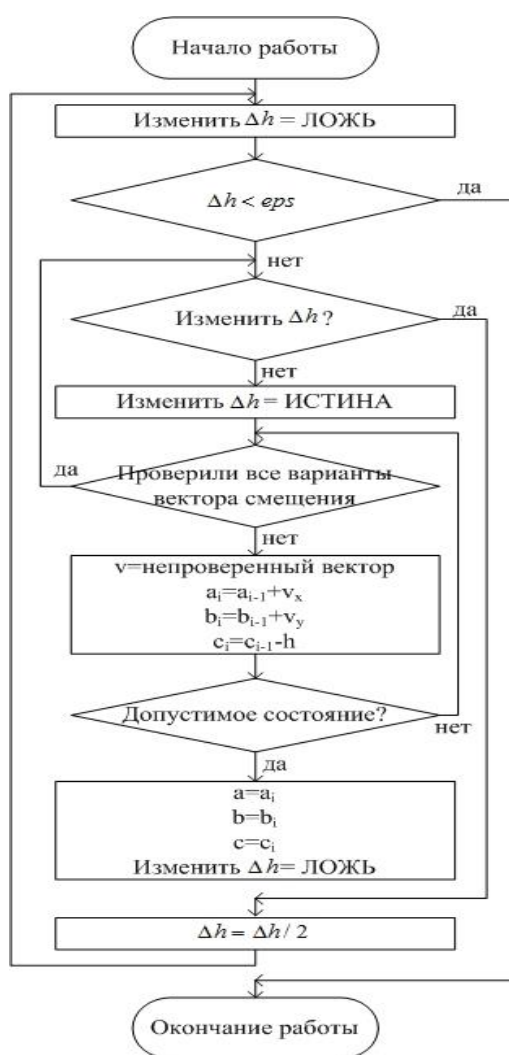
Рисунок 3.10 – Блок-схема алгоритма определения максимального перекрытия
