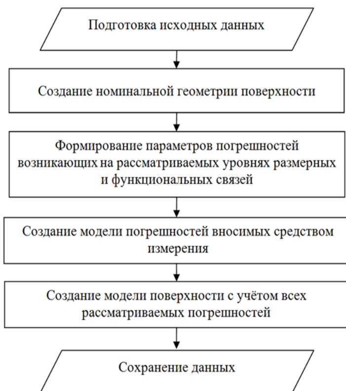
Рисунок 2.18 – Блок-схема создания моделей поверхностей деталей с заданными геометрическими отклонениями
