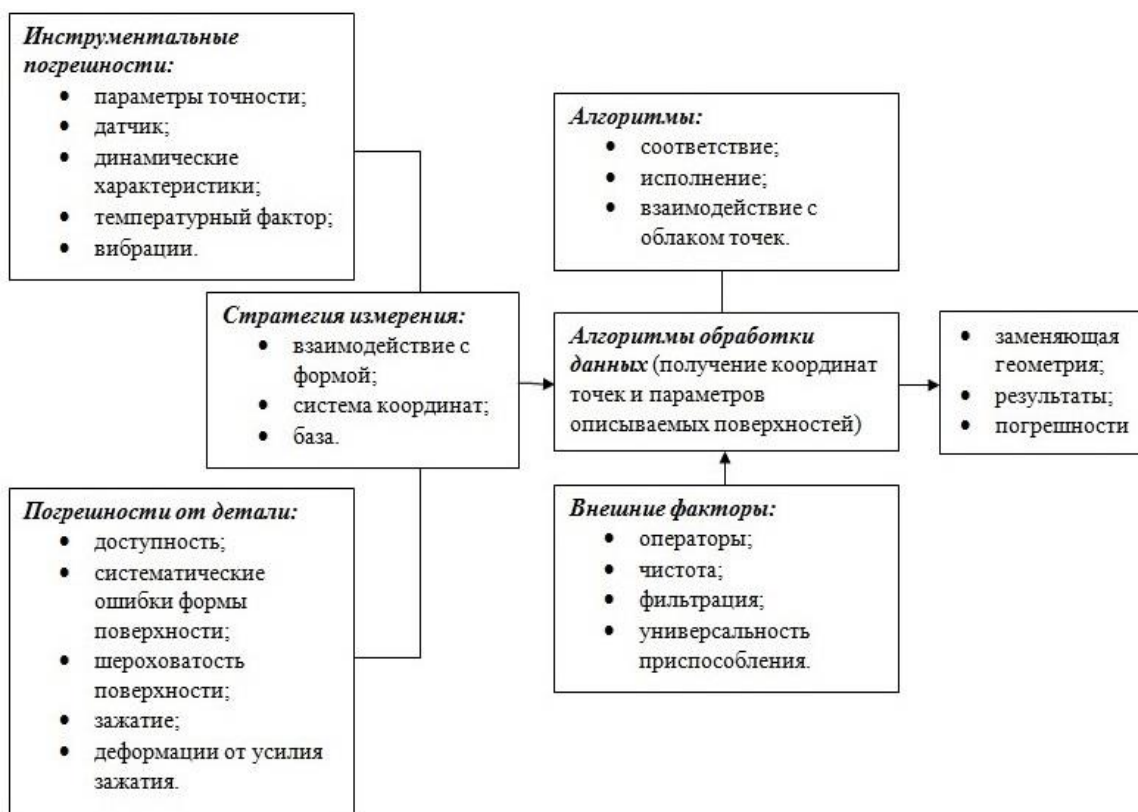
Рисунок 1.2 – Факторы, влияющие на погрешность измерения геометрических параметров КИМ [192]
