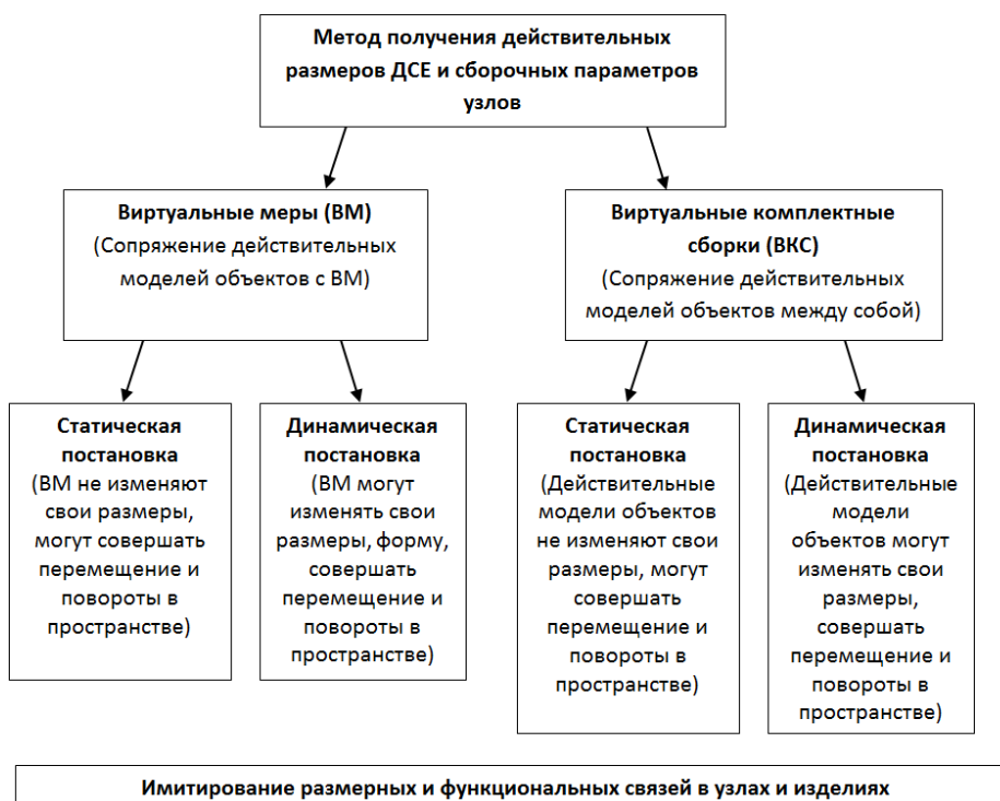
Рисунок 2.3 – Метод получения действительных размеров ДСЕ и сборочных параметров узлов
