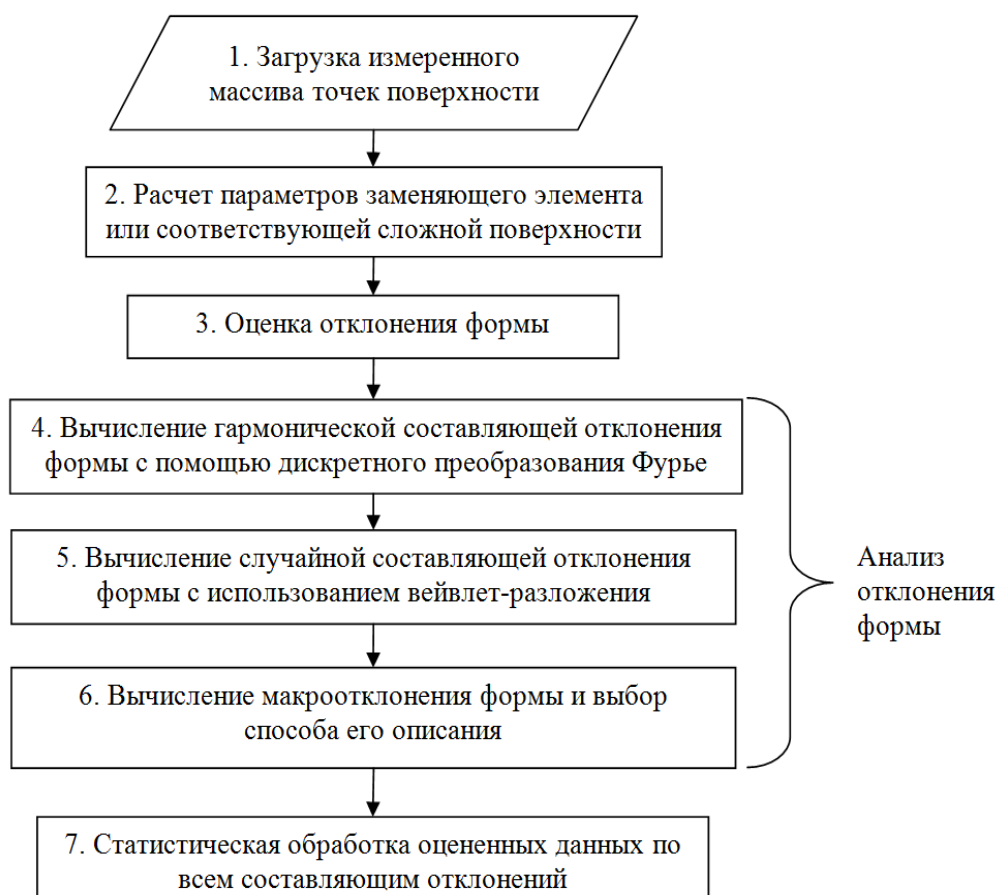
Рисунок 2.9 – Блок-схема методики анализа геометрических отклонений поверхностей деталей
