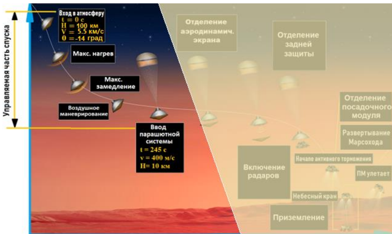
Рисунок 1.8 – Схема спуска в атмосфере Марса
