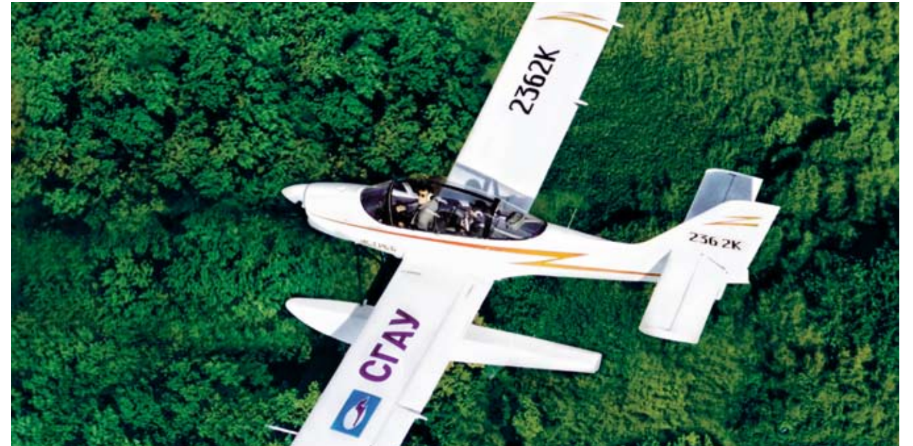
Легкий самолет «Ястреб» разработан в СГАУ как многоцелевой самолет с высокой грузоподъемностью для российских условий эксплуатации. Широкая кабина спроектирована под пилота ростом 1,9 м. У самолета — прочное шасси, позволяющее взлетать как с бетона, так и с грунта. Управление — простое, пропорциональное, дублированное. Большая грузоподъемность и хорошая энерговооруженность дают возможность использовать самолет на авиационных работах, для чего на самолет устанавливается хвостовая форсунка с баком емкостью до 260 л.
