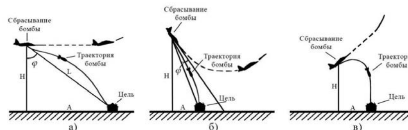
Рисунок 1 – Методики бомбометания: а) горизонтальное, б) с пикированием, в) с кабрированием
