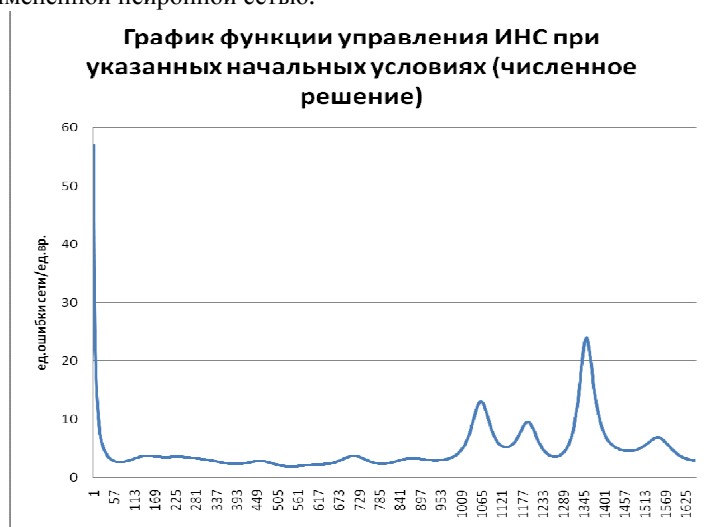
Рис.1 – Полученное решение в виде функции K(t) (согласно (7))
