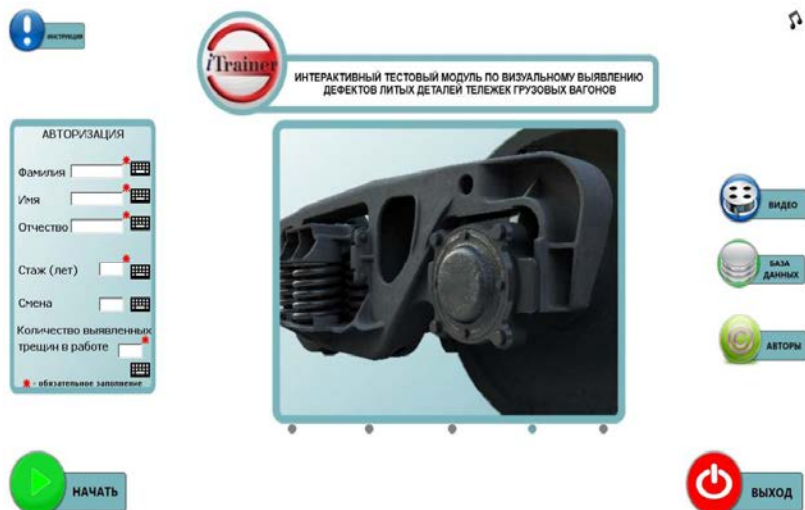
Рисунок 3. ПО «Выявление дефектов литых деталей тележек грузовых вагонов»
