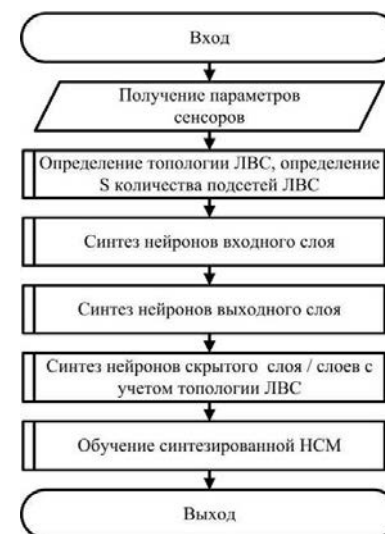
Рис. 1. Алгоритм синтеза нейроструктурной модели системы принятия решений при ликвидации сетевых проблем
