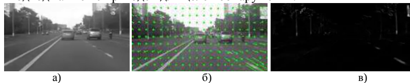
Рис.2. а) обычная последовательность из шоссе. Применение методов: б) опико-поток, в) вычитание фона
