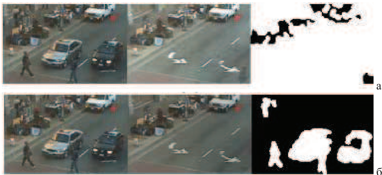
Рис. 1. Обнаружение объектов при изменяющейся освещенности: без компенсации изменений освещенности (а), с компенсацией (б)
