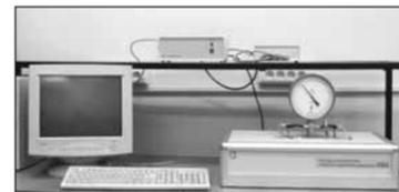
Лабораторный стенд исследования датчика давления
